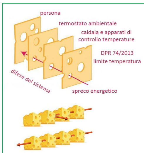
Declinazione della Teoria del Formaggio Svizzero di James Reason sul fattore umano
